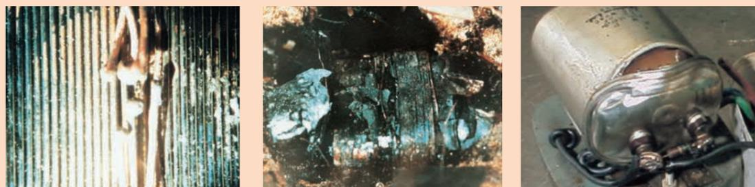
寿命末期のコイルレヤーショートから短時間の異常発熱によりコイル断線(不点灯)したもの。
